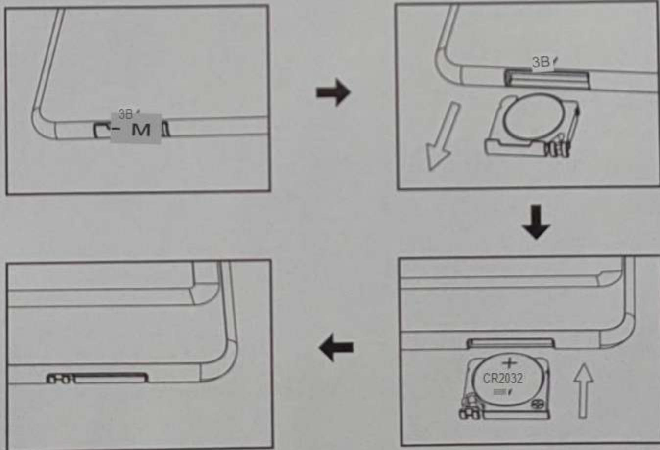
Замените аккумулятор: отсоедините держатель аккумулятора, извлеките аккумулятор и замените кнопочную батарею CR2032 [3V].
