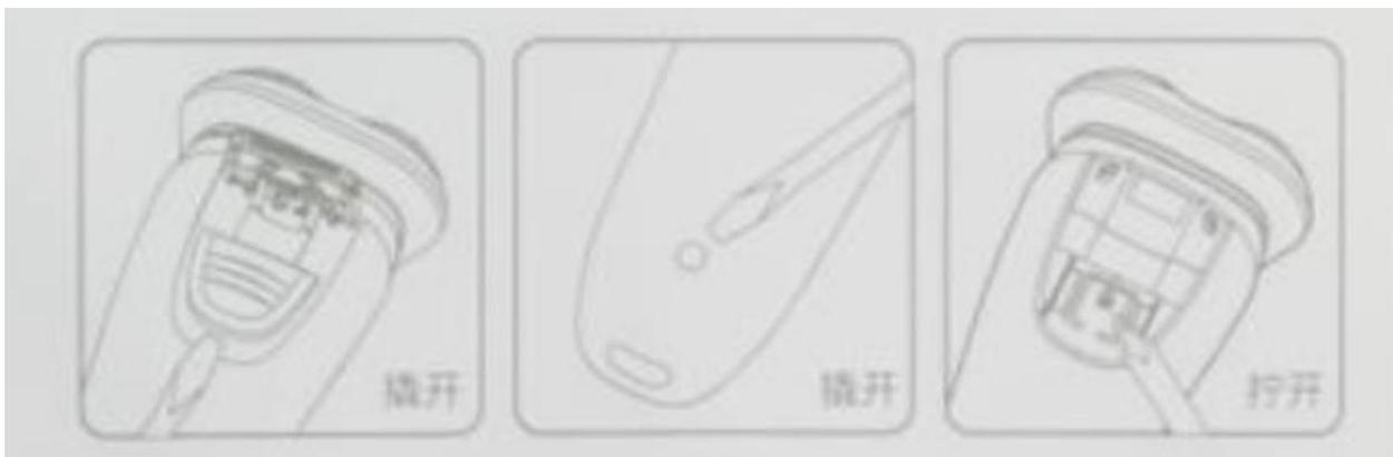
Открутите винты водонепроницаемой крышки с помощью поперечного кусачки и снимите водонепроницаемую крышку;
