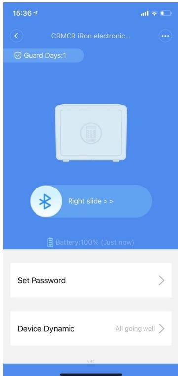
Для того чтобы сохранить или удалить из памяти устройства пароль, перейдите в раздел «Set Password». Для того чтобы добавить постоянный пароль, нажмите клавишу «+» в верхнем правом углу экрана и следуйте инструкции. Для создания одноразового пароля перейдите в раздел «One-time Password». Пароль, сгенерированный в этой графе, будет работать всего один раз.
