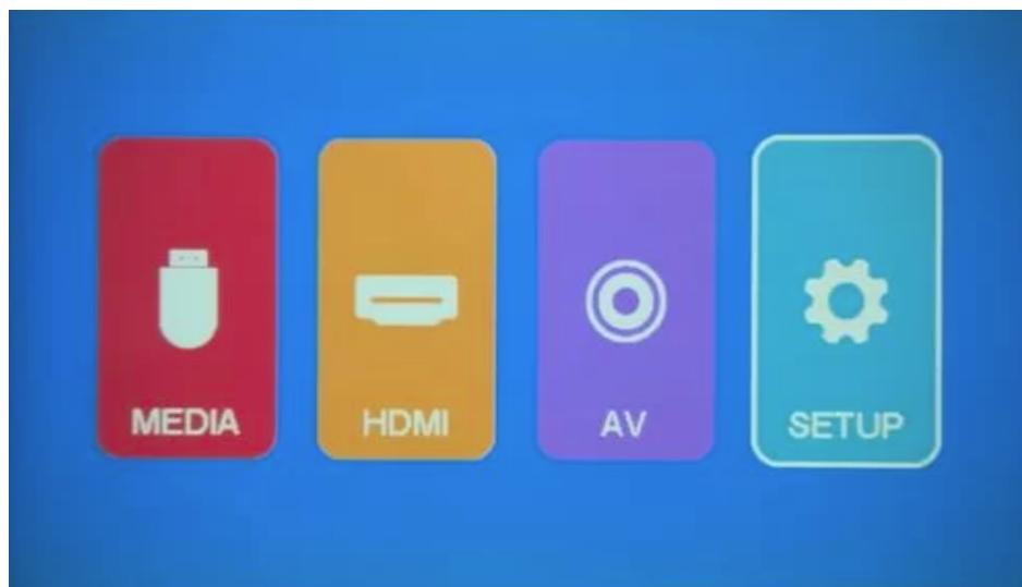
В основном меню вы можете выбрать источник сигнала (HDMI, AV) или открыть подключенный накопитель, чтобы выбрать файл для проигрывания (Media). Раздел Setup содержит настройки изображения (Picture) и звука (Sound). В меню настройки изображения вы можете отрегулировать контраст, яркость,
