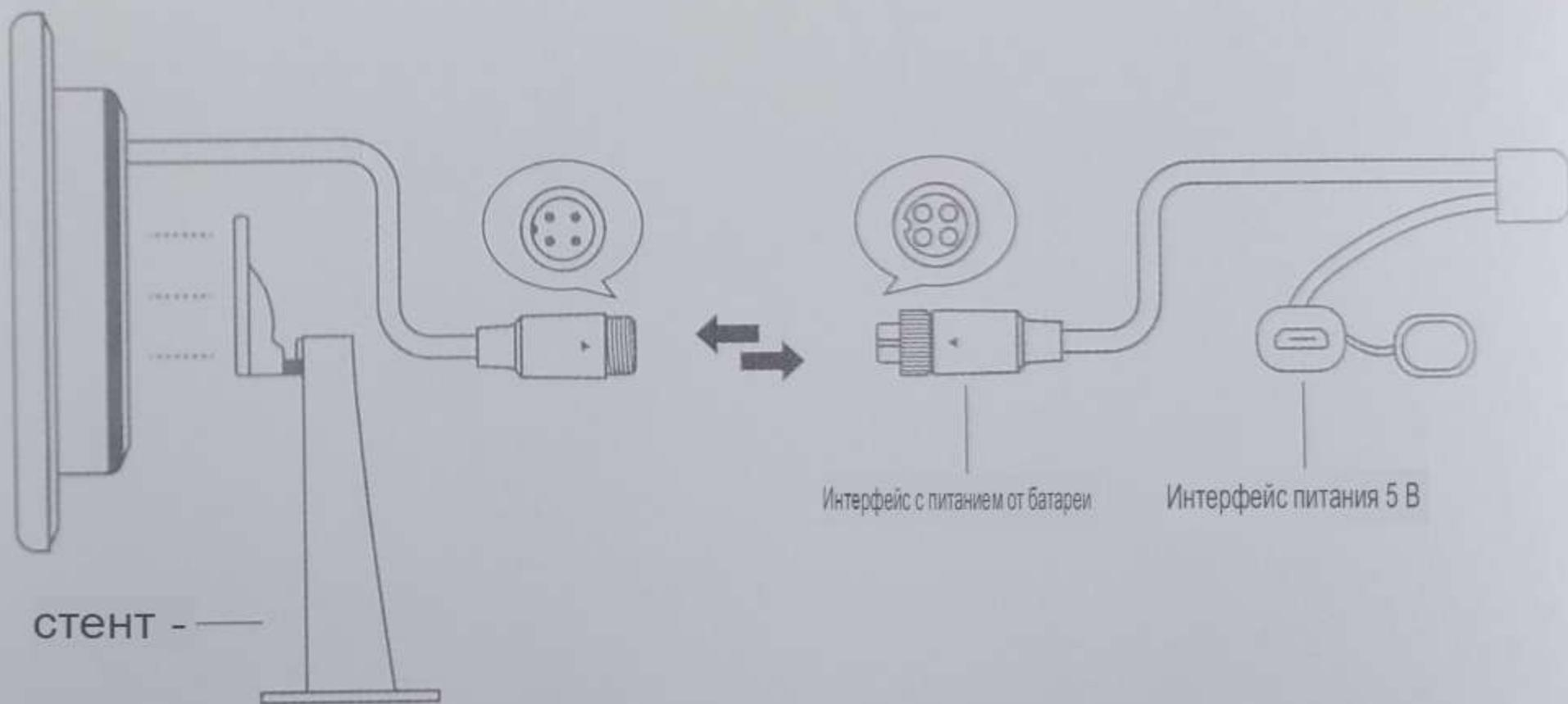
\* Если вы используете адаптер питания 5 В / 2 А для питания, пожалуйста, вставьте SIM-карту в камеру, а затем подключите шнур питания адаптера к источнику питания 5 В устройства.
