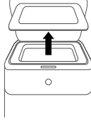
2. أزل الحلقة المغناطيسية الخارجية
