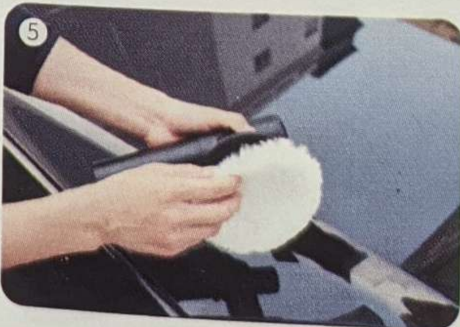
5. После высыхания прикрепите к полировальной машине подушку из полировальной шерсти.
