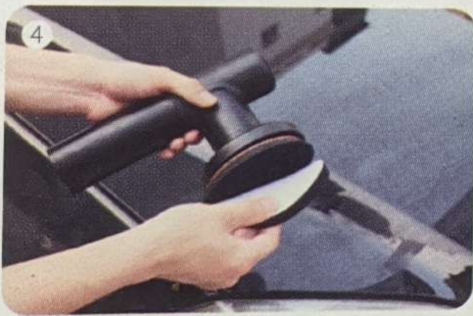
4. Прикрепите к полировщику плоскую поролоновую подушечку и продолжайте равномерно натирать ее воском.
