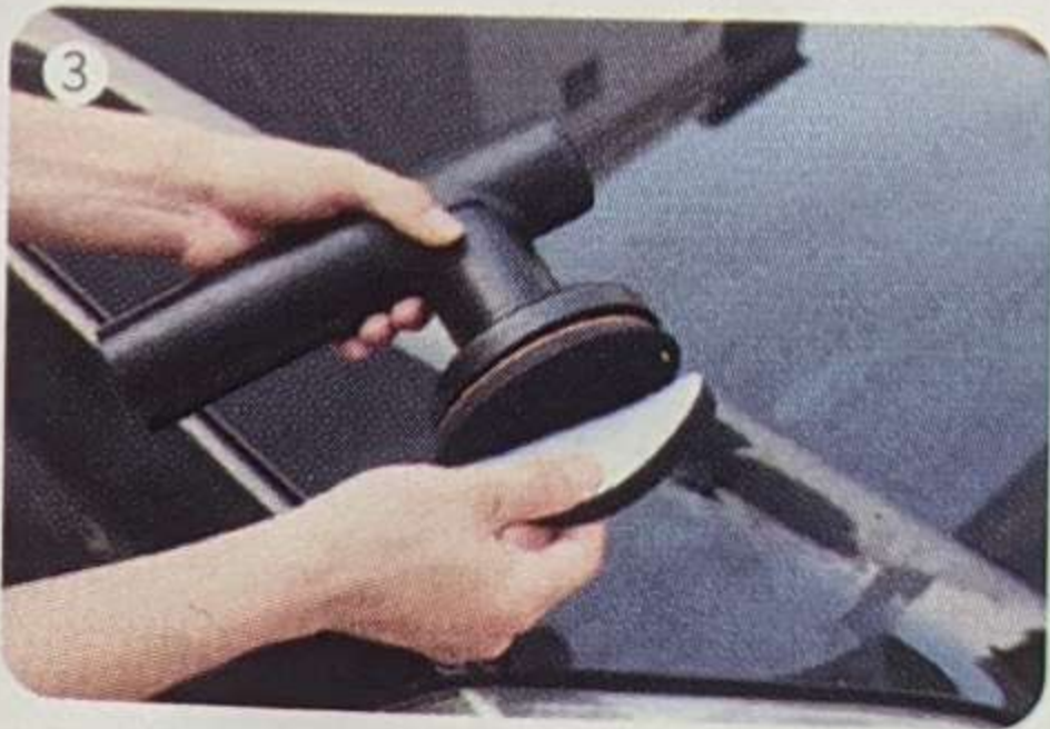
3. Приложите к полировщику плоскую поролоновую подушку и продолжайте равномерно натирать ее воском.
