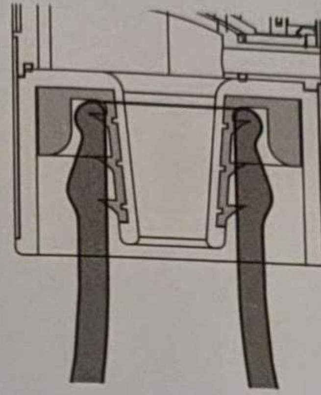
※Различные размеры горлышка бутылки могут иметь разную герметичность при нажатии на горлышко бутылки внутрь.
