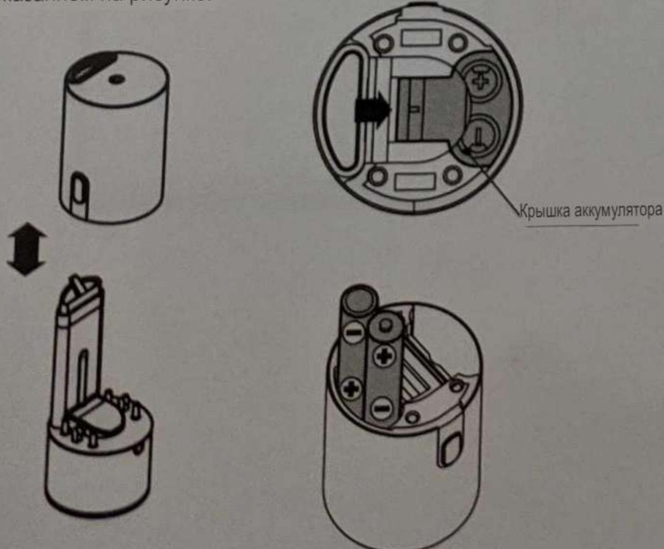
Можно использовать щелочную батарею типа AAA или Ni-MH аккумуляторную батарею типа AAA.
