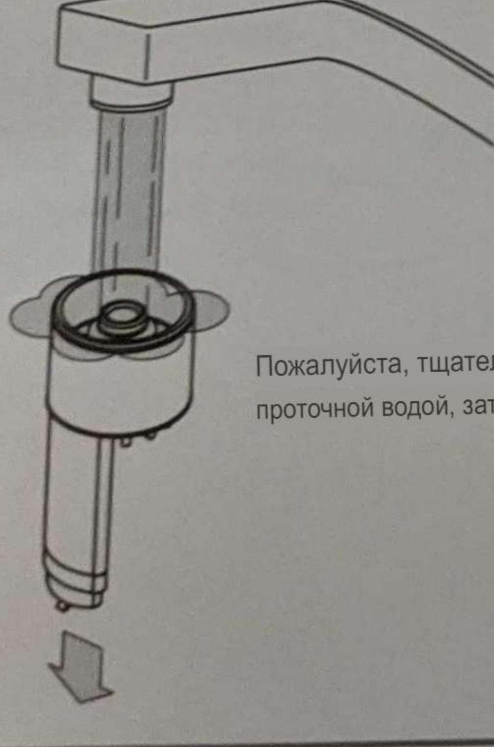
Пожалуйста, тщательно промойте нижнюю часть проточной водой, затем высушите на воздухе.
