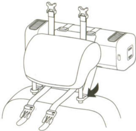
2. Надежно затяните ремни крепления, чтобы между устройством и подголовником не было свободного пространства, таким образом, воздухоочиститель будет надежно зафиксирован. Прежде чем затягивать ремни до предела, используйте специальный кожаный чехол, чтобы скрыть излишнюю длину ремней.
