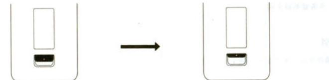
Нажмите на ручку, чтобы открыть защитную панель отсека для фильтра
