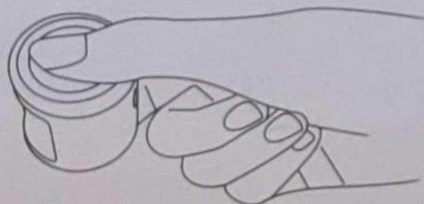
3. Определите направление обнаружения датчика человеческого тела и вставьте датчик человеческого тела в положение установки.
