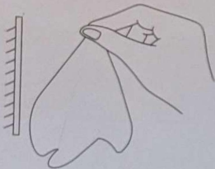
2. Приклейте клейкую ленту к нижней части крышки батарейного отсека и равномерно нажимайте в течение 30 секунд, чтобы убедиться, что паста прочная.
