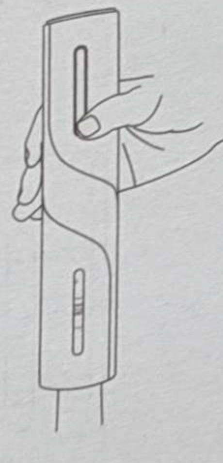
Нажмите верхнюю спусковую кнопку и удерживайте в течение 5-7 секунд, пробка автоматически выйдет из открывалки, отпустите кнопку и завершите процесс открывания.
