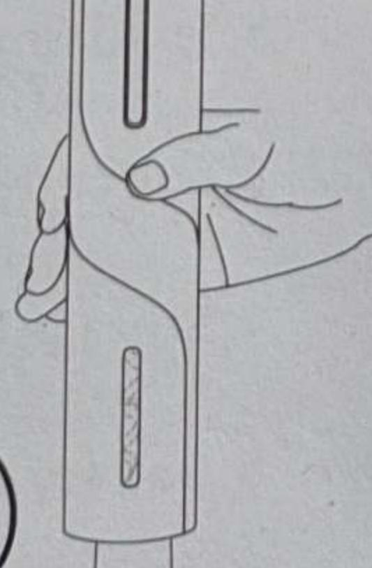
Нажмите кнопку извлечения и, удерживая ее, одновременно слегка надавите на корпус открывалки вниз. Спираль повернется по часовой стрелке и войдет в пробку, затем постепенно вынет ее из бутылки через 6-8 секунд. Когда пробка полностью извлечена, открывалка для вина автоматически останавливается.
