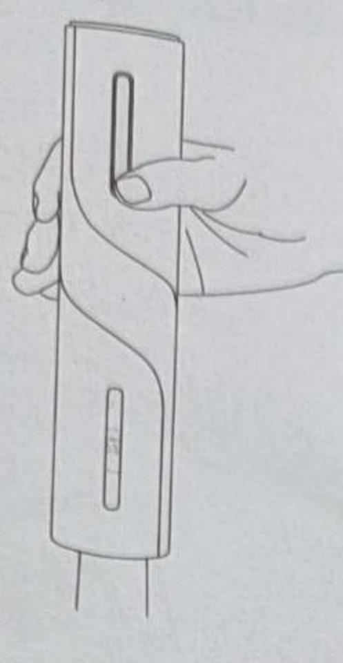
Нажмите кнопку обратного подключения выше и удерживайте ее в течение примерно 5-7 секунд После этого винная пробка автоматически выйдет из основного корпуса штопора, Отпустите кнопку, и весь процесс закончится.
