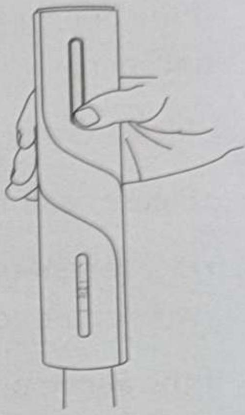
Нажмите верхнюю спусковую кнопку и удерживайте в течение 5-7 секунд, пробка автоматически выйдет из открывалки, отпустите кнопку и завершите процесс открывания.
