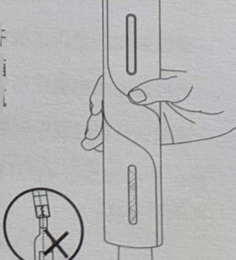
Нажмите кнопку открыть бутылку и удерживайте ее, слегка опуская вниз Нажмите на основной корпус штопора примерно на 6-8 секунд, и штопор автоматически Вытащите пробку из красного вина, когда пробка будет полностью извлечена, Штопор автоматически перестанет работать, и в это время его можно будет отпустить Нажмите кнопку бутылки и извлеките открывалку из бутылки.
