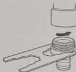
Выберите подходящий адаптер (в соответствии с направлением резьбы и линейкой аэратора ⚡
