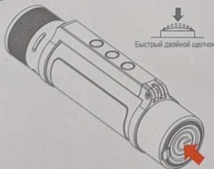
Примечание: Есть память! режим для фонарика; то есть, каждый раз, когда он включается, он запускается с режима, в котором, когда он выключен, истекает время.
