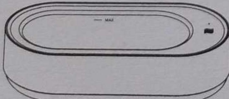
\*После каждой чистки, пожалуйста, сливайте воду из машины, даже если она используется только один раз, ее необходимо спить. \*При использовании машины несколько раз подряд индикатор будет мигать красным, чтобы избежать повреждения и выхода из строя деталей из-за перегрева., В это время машина переходит на время охлаждения системы и может быть восстановлена для использования примерно через 5 минут.
