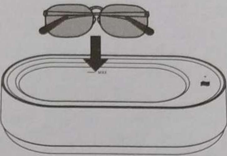
\*Объектив не должен находиться в непосредственной контакте с канавкой из нержавеющей стали.
