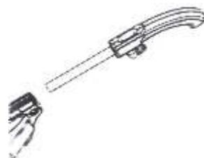
1. Откройте фиксатор металлической трубки, вытащите трубку.
