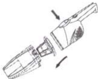
Откройте пылесборник, извлеките фильтр, промойте его водой и высушите.
