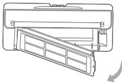
Чтобы очистить фильтр в контейнере для пыли и в контейнере для пыли с отсеком для воды "два-в-одном", извлеките его, как показано на схеме.
