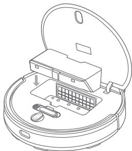
1. Откройте крышку робота-пылесоса и установите контейнер для пыли или контейнер для пыли с отсеком для воды "два-в-одном" в указанном направлении до полной фиксации.
