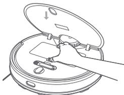
4. Верните контейнер для пыли на место до полной фиксации и закройте крышку робота-пылесоса.
