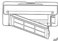
1. Откройте крышку робота-пылесоса, извлеките контейнер для пыли с отсеком для воды "два-в-одном", а затем достаньте фильтр, как показано на рисунке.
