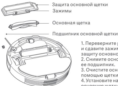
1. Переверните робот-пылесос и сдавите зажимы, чтобы снять защиту основной щетки.
