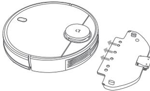
4. Зафиксируйте зажимы, установите держатель насадки для влажной уборки горизонтально на нижней части робота-пылесоса, как показано на рисунке.
