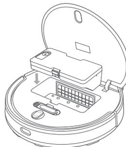
2. Поместите контейнер для пыли с отсеком для воды "два-в-одном" внутрь робота-пылесоса до полной фиксации.
