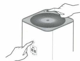
Если ваш смартфон не подключается к воздухоочистителю, пожалуйста, нажмите одновременно на кнопки «переключение режимов» и «включения / выключения дисплея» и удерживайте их в течение 5 секунд, пока не услышите характерный звуковой сигнал, указывающий на успешный сброс настроек Wi-Fi .
