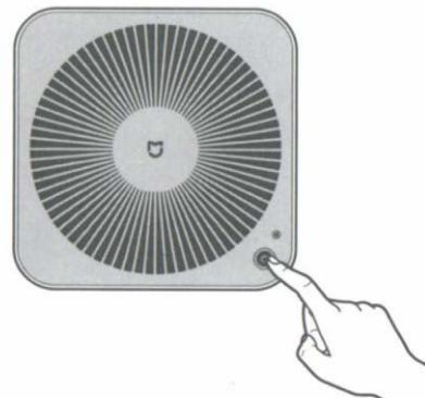
Нажмите на кнопку «Включение / выключение дисплея», чтобы включить или выключить его.
