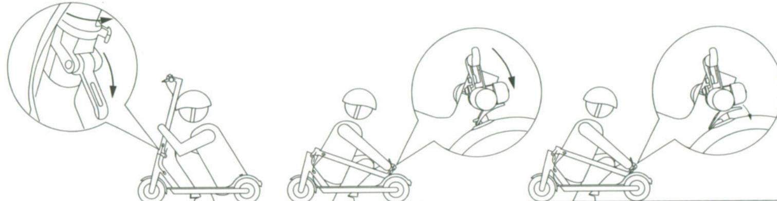
Убедитесь, что транспортное средство выключено. Ослабьте фиксатор и опустите рычаг рулевой стойки. Сложив рулевую стойку в горизонтальное положение, зафиксируйте ее, продев специальное кольцо через крючок, который расположен на брызговике заднего колеса. Чтобы собрать самокат, необходимо отсоединить фиксатор рулевой стойки от крючка брызговика, после чего поднимите ее в вертикальное положение и зафиксируйте рычаг.
